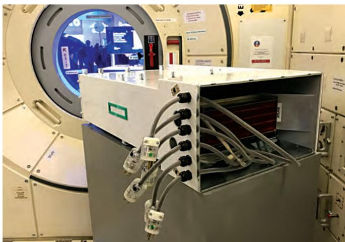
**Рис. 9.** Высокопроизводительный космический кластер HPE Spaceborne на базе стандартных компонент успешно прошел испытания на орбите
