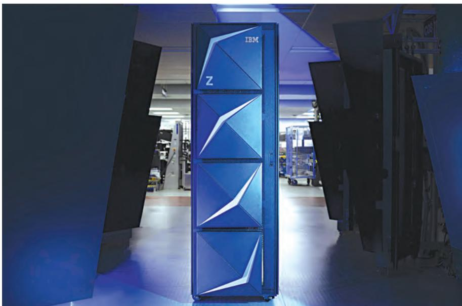
**Рис. 12.** Мейнфрейм IBM z15, представленный в 2019 году, рассчитан на обработку до триллиона транзакций в день (при максимальной комплектации, состоящей из четырех стоек)
