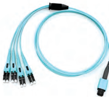
Рис. 12. Оптический шнур Corning длиной 15 м, с одной стороны которого находится 8-волоконный оптический коннектор MTP, с другой — четыре кабеля с LC-дуплексными разъемами, в которых можно изменять поляриность
