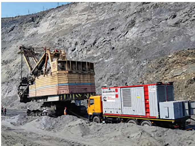
Рис. 2. Дизель-генератор Cummins, используемый для перемещения экскаватора
