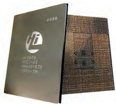
Рис. 11. Чип Kunpeng 920 (HiSilicon Hi1620), созданный инженерами компании Huawei на базе микроархитектуры ARM 8.2-A по нормам 7 нм техпроцесса
