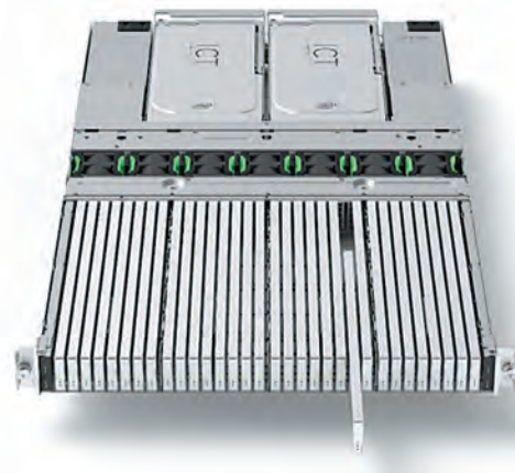
Рис. 16. Схема установки SSD-накопителей форм-фактора EDSFF в 1U сервере
