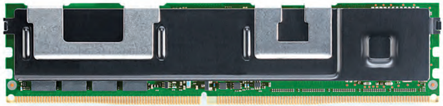
Рис. 14. Модуль энергонезависимой памяти Intel Optane DC Persistent Memory на основе фирменной технологии 3D XPoint
