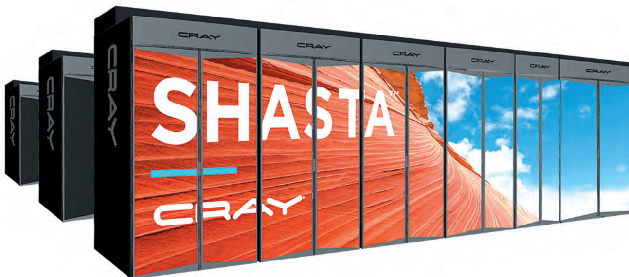
Рис. 18. Суперкомпьютер Cray Shasta способен объединять в рамках одной вычислительной системы процессоры x86, ARM, а также GPU и FPGA
