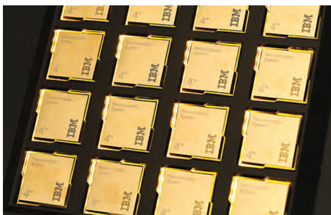
Рис. 3. Нейроморфные процессоры IBM TrueNorth
