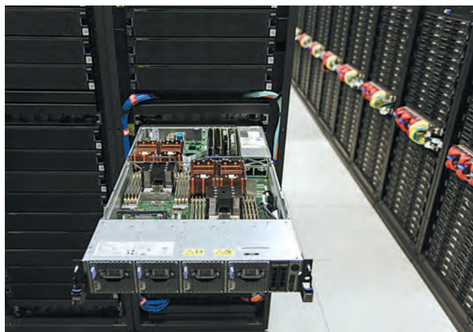
Рис. 1. Power Systems AC922 — первый серийный сервер компании IBM на базе нового процессора POWER9
