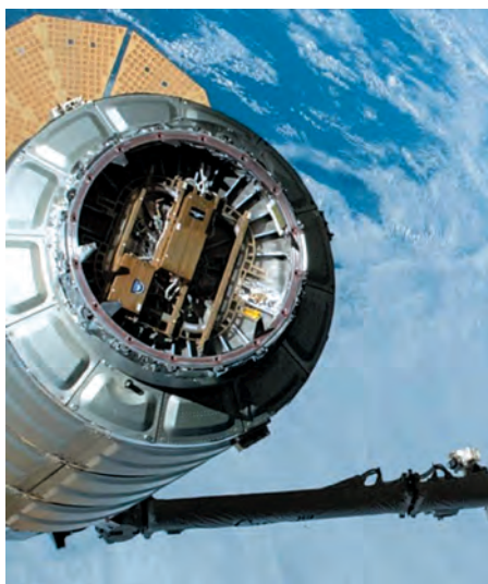
Рис. 5. «Базовая станция» Ubiquitilink на торце грузовика Cygnus
