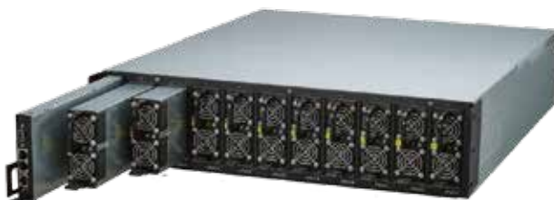
Рис. 9. ИБП для ЦОД производства Lite-On Power System Solutions за счет использования Li-ion АКБ позволяет установить до 25 кВт мощности (22,5 кВт с учетом резервирования N+1) при собственной высоте 2U
