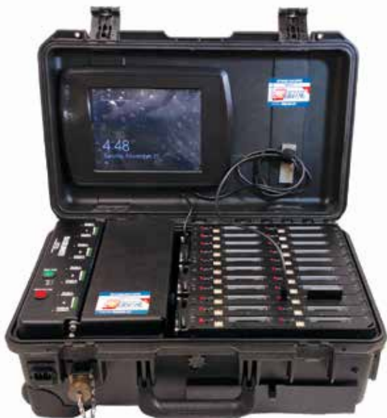
Рис. 3. Дата-центр в чемодане, разработанный Arnouse Digital Devices Corp по заказу Минобороны США
