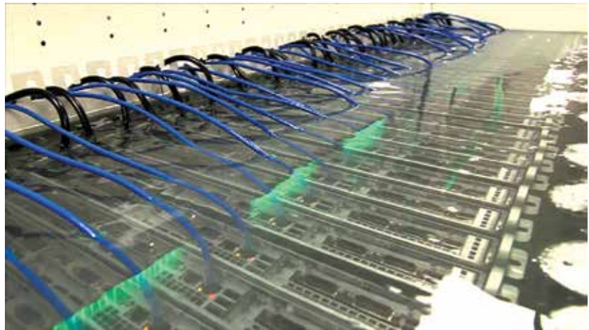
Рис. 2. Система иммерсионного охлаждения серверов Green Revolution Cooling в действии
