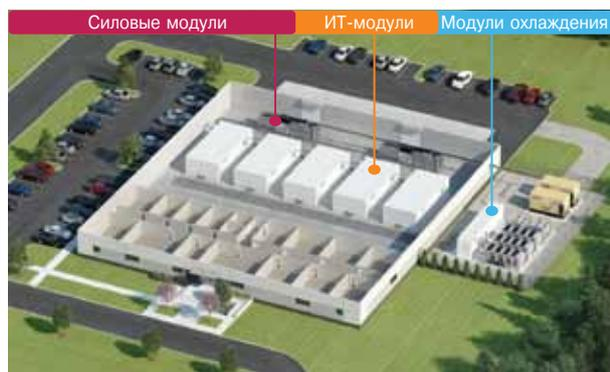
Рис. 2. Концепция модульного дата-центра по версии Schneider Electric
